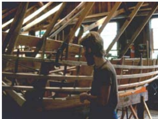
Så er skibet klat til at få monteret bordplanker.
