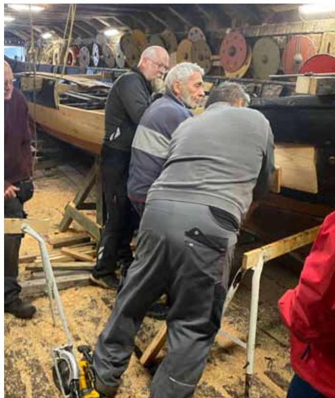
Planken presses på plads (forår 2025)
