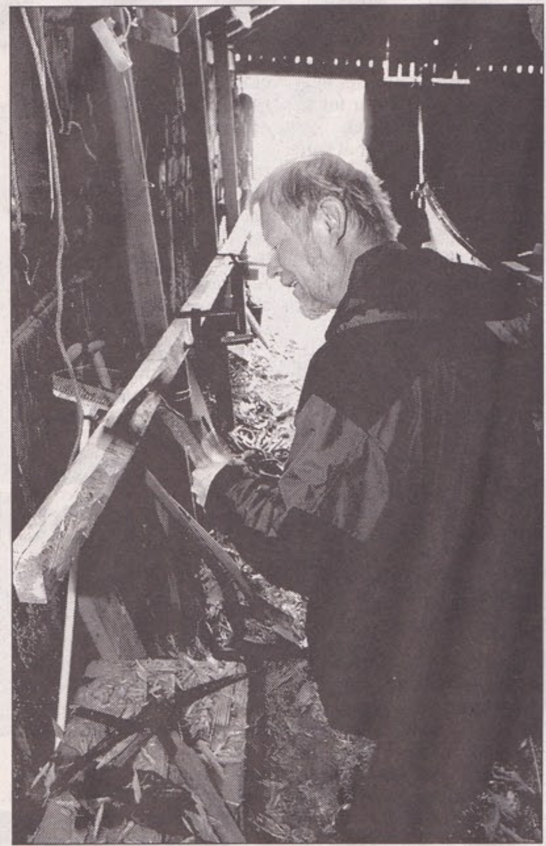
Den specielle vikingøkse er flittigt i brug i nausten ved Augustenborg. Her viser Steen Weile, hvordan man kan hugge spåner af en planke uden de store problemer, fordi øksens hoved nærmest er formet som en hakkejern.
