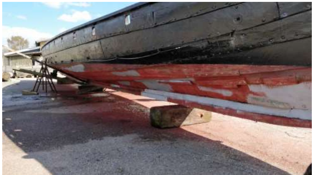
Efter rengøring var der mange bare pletter – så skal der primes inden bundsmøring kommer på.
